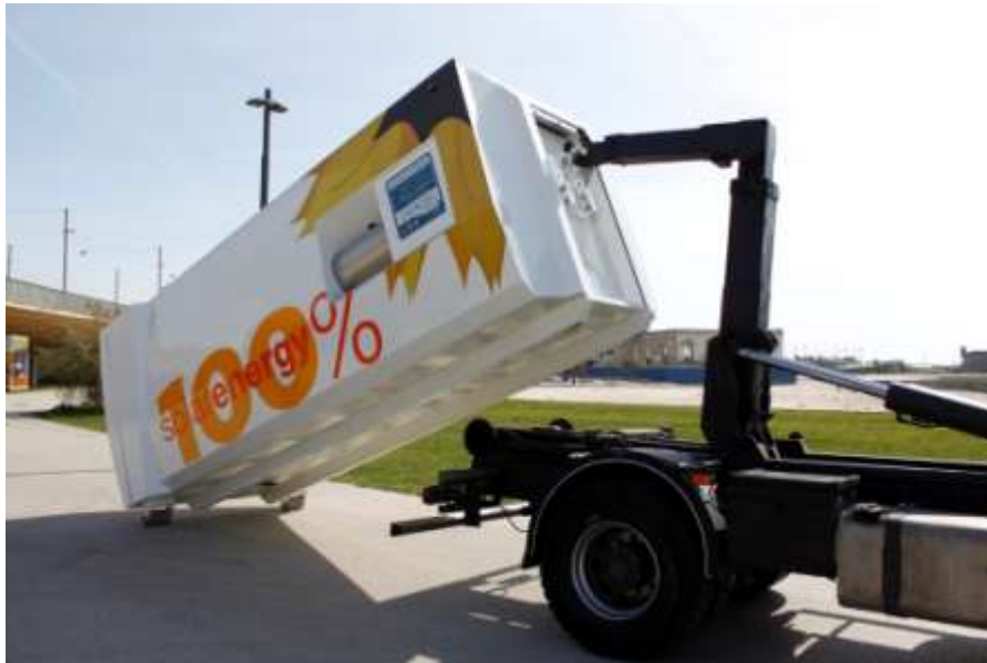
Εικόνα 28 Container υπέργειο ενεργειακής αυτονομίας - Φόρτωση
