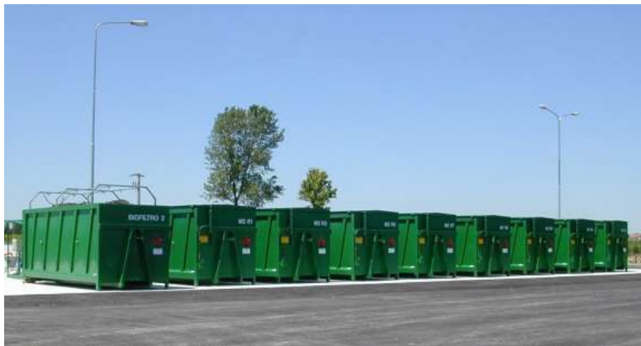
Εικόνα 36 Διάταξη-Σύστημα φορητών βιοαντιδραστήρων
