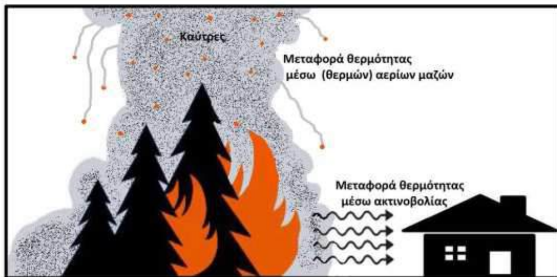
Σχέδιο 2. Τρόποι ροής της θερμότητας σε δασική πυρκαγιά, που εξελίσσεται πλησίον κτιρίου & απεικόνιση πιθανής μετάδοσης δασικής πυρκαγιάς με μεταφερόμενες καύτρες σε κτίρια χωρίς την παρουσία ανέμου σε συνθήκες πρόσκαιρης νηνεμίας, ή ατμοσφαιρικής ευστάθειας.
