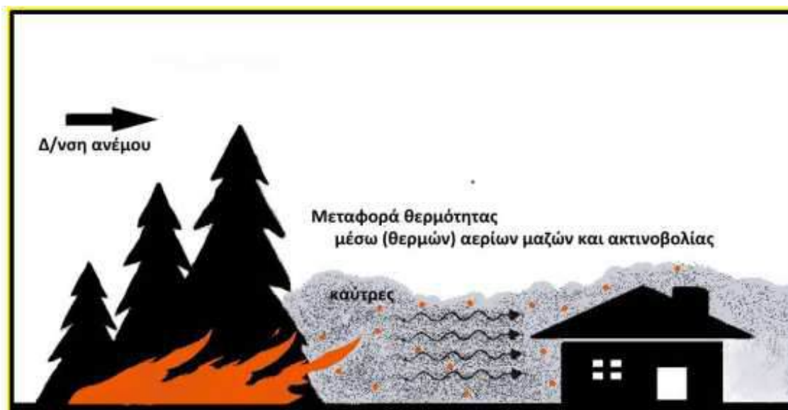
Σχέδιο 4. Τρόποι ροής της θερμότητας σε μια δασική πυρκαγιά, που εξελίσσεται πλησίον κτιρίου & απεικόνιση πιθανού τρόπου μετάδοσης δασικής πυρκαγιάς με μεταφερόμενες καύτρες σε κτίρια παρουσία ισχυρού άνεμου
