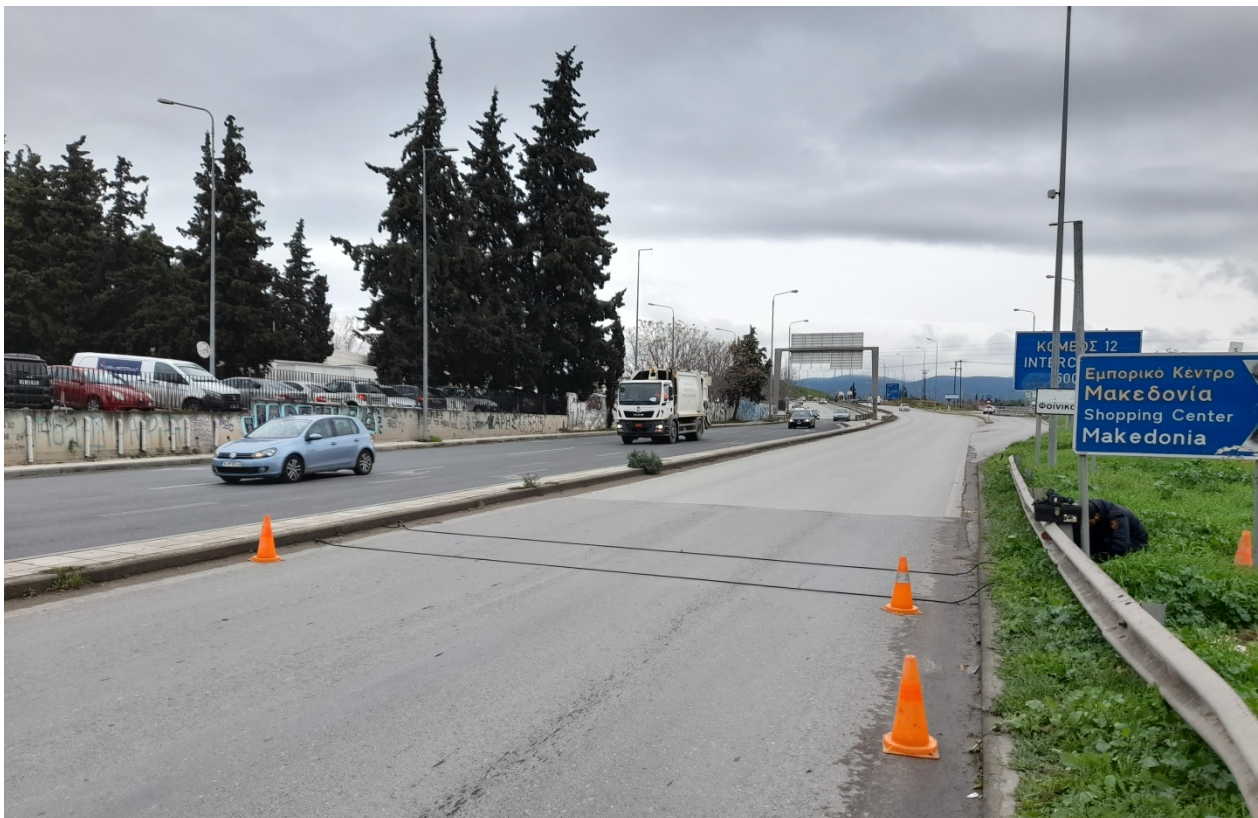
Σχήμα 3.3: Απεικόνιση των αυτόματων μετρητών κυκλοφορίας τύπου πνευματικού σωλήνα που θα χρησιμοποιηθούν για την εκπόνηση μετρήσεων σε οδικά τμήματα στο πλαίσιο του ΣΒΑΚ του Δήμου Κορδελιού-Ευόσμου
